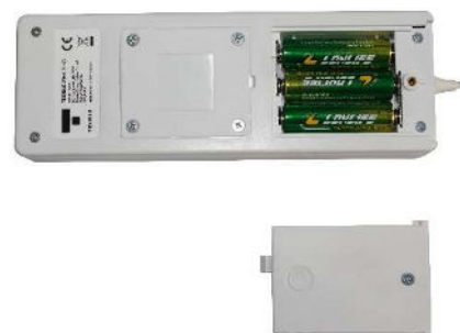
Foto 60 – Zender met geopende batterijklep; benodigde batterijen: AA 1,5V
