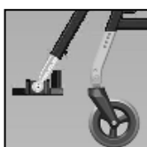
T2-F: 4 gaten zichtbaar
